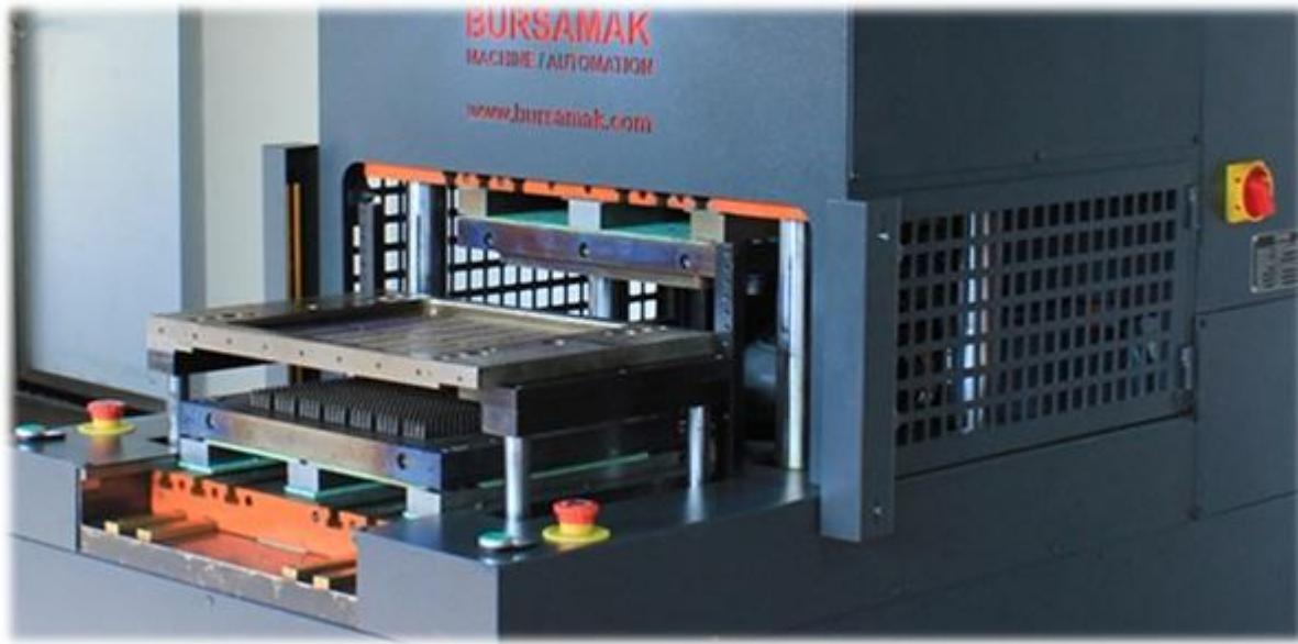
Los eyectores centrales y laterales de accionamiento hidráulico permiten expulsar automáticamente las piezas del molde. Esto reduce significativamente el tiempo de producción y aumenta el volumen de producción.
