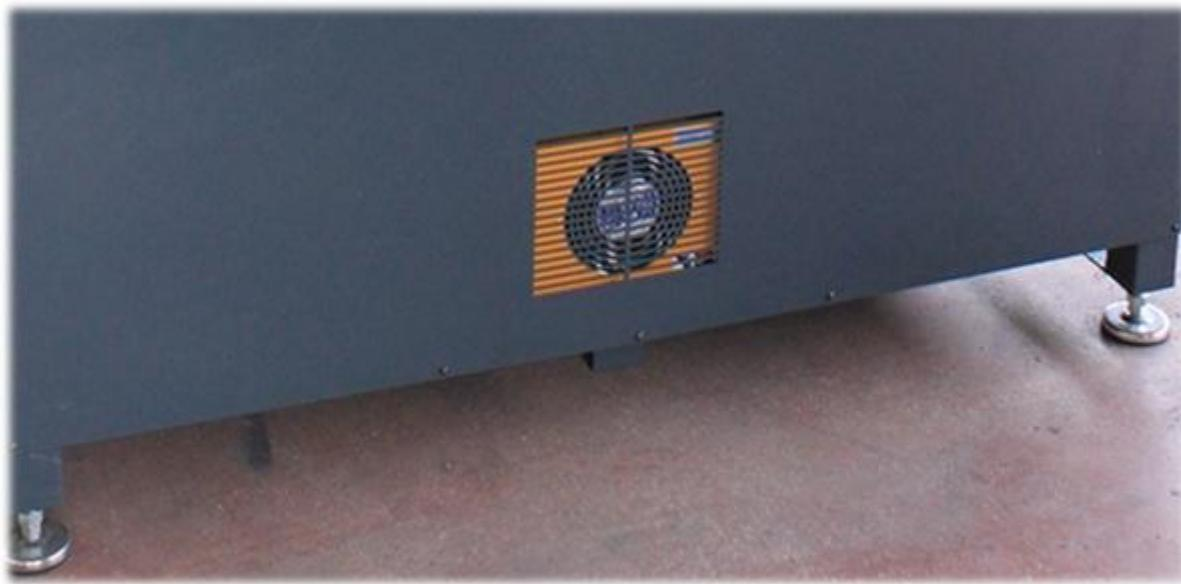
Gracias al sistema de refrigeración de aceite de nuestras prensas, la máquina enfriá automáticamente el aceite hidráulico cuando la temperatura supera la especificada, evitando así cualquier pérdida de potencia y prolongando la vida útil de sus fieltros.
